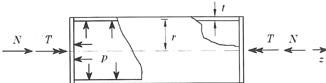
Figuren viser en beholder laget av et sirkulært rør med midlere radius  $r = 100$  mm og veggtykkelse  $t = 5$  mm. Beholderen kan belastes med et indre trykk  $p$ , et torsjonsmoment  $T$  og en aksialkraft  $N$  (Strekk eller trykk). Flytespenning  $f_y = 260$  MPa.
