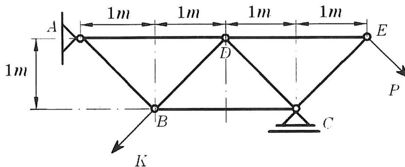
Figuren viser et fagverk opplagret med et fast boltelager i  $A$  og et glidelager i  $C$ . Dimensjoner i meter som vist på figuren. Fagverket er belastet med en kraft  $P = 12\sqrt{2}$  kN i  $E$  og en kraft  $K = 18\sqrt{2}$  kN i  $B$ . Begge kreftene danner  $45^\circ$  med horisontalen.
