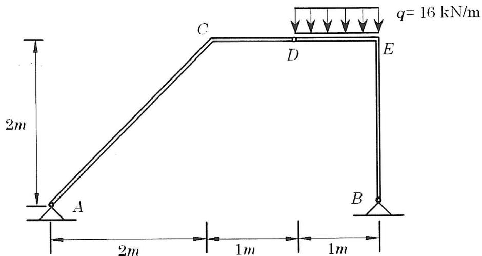
Figuren viser en ramme som er opplagret med faste boltelagre i  $A$  og  $B$  og som har et indre ledd i  $D$ . Ramma består av skråbjelken  $AC$  som er stivt forbundet med den horisontale bjelken  $CD$  og bjelken  $DE$  som er stivt forbundet med den vertikale bjelken  $EB$ . Dimensjoner i meter som angitt på figuren.
