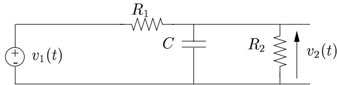
Vi definerer inngangssignalet som spenninga  $v_1(t)$  og utgangssignalet som spenninga  $v_2(t)$ .
