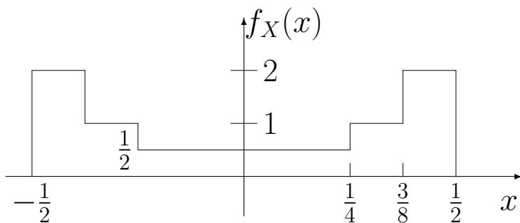
Signalet kvantiseres uniformt med kvantiseringsintervallene  $\Delta = 1/8$ .
