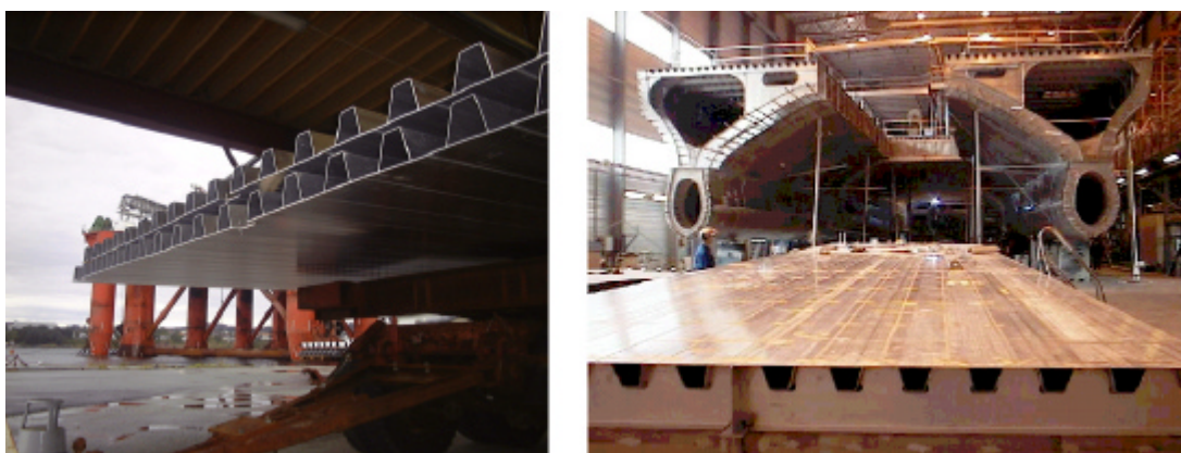
Figur 8-36 Ekstruderte profiler som er sammenføyd ved hjelp av FSW [ Production of wide aluminium profiles by solid-state friction stir welding ]. Ole T. Midling og Helge G. Johansen.].
