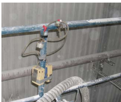
Figur 1: Oppstilling av dosimeter for å måle totalt og respirabelt støv
