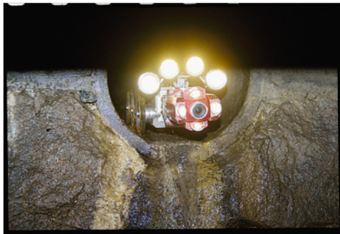
Figur 5.5: Kamera for innvendig TV-inspeksjon av rør (NORVAR rapport 150/2007).
